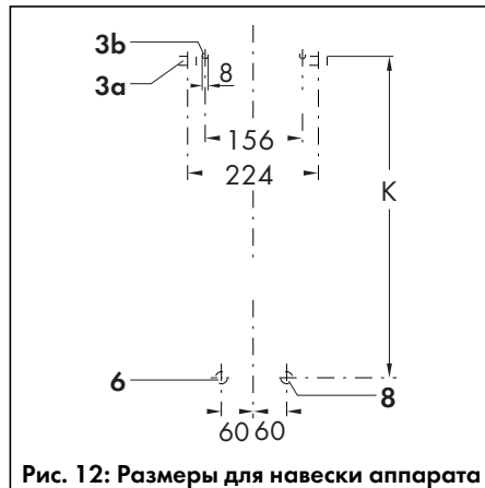
Рис. 12: Размеры для навески аппарата
