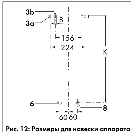
Рис. 12: Размеры для навески аппарата
