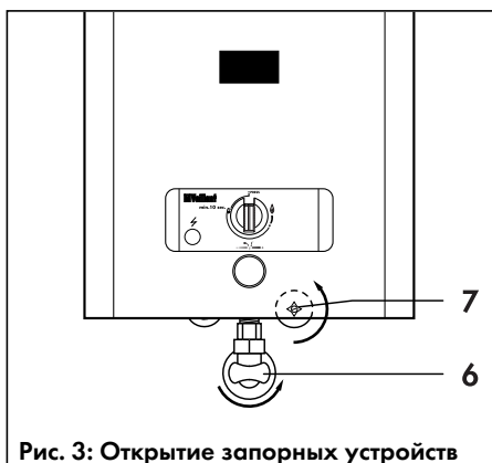
Рис. 3: Открытие запорных устройств
